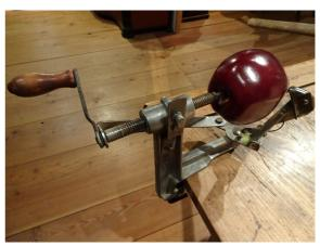
Der Apfel sitzt fest und dreht auf dem Dorn der Welle, mit der Kurbel bewegt man die Welle mit dem Apfel nach vorne zum Schälmesser, welches zudem über ein Metallband von der Welle gesteuert um den Apfel herum bewegt wird.
